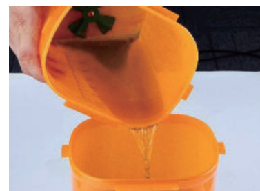
③ 다른 용기에 알코올 상당 층을 부어버리고 잔존물을 폐기한다. (예, 알코올이 완전히 증발하고 레진이 경화될 때까지 잔여물에 직사광선을 노출한다. 레진이 경화되어 고체화되면 폐기한다.)
